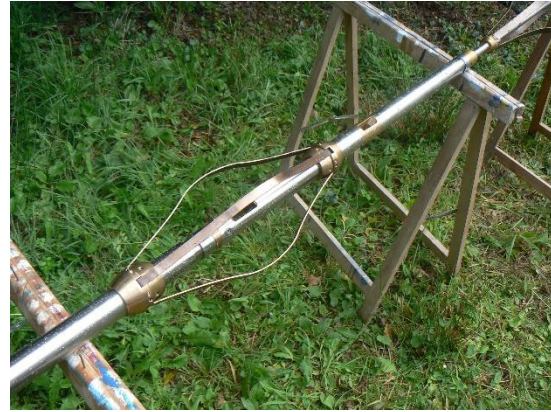
Sonde temp/cond avec centreur en ligne
