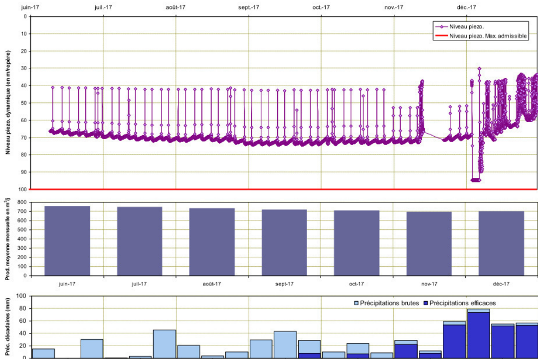
Figure 13 : Exemple de bilan de production établi pour un forage industriel dans les Cotes d'Armor
